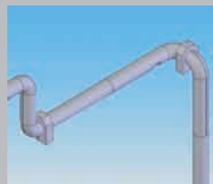
●ガス配管 / サニタリー配管の加熱・保温 ●結晶化防止
