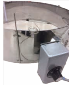
▶センサー取付部分
